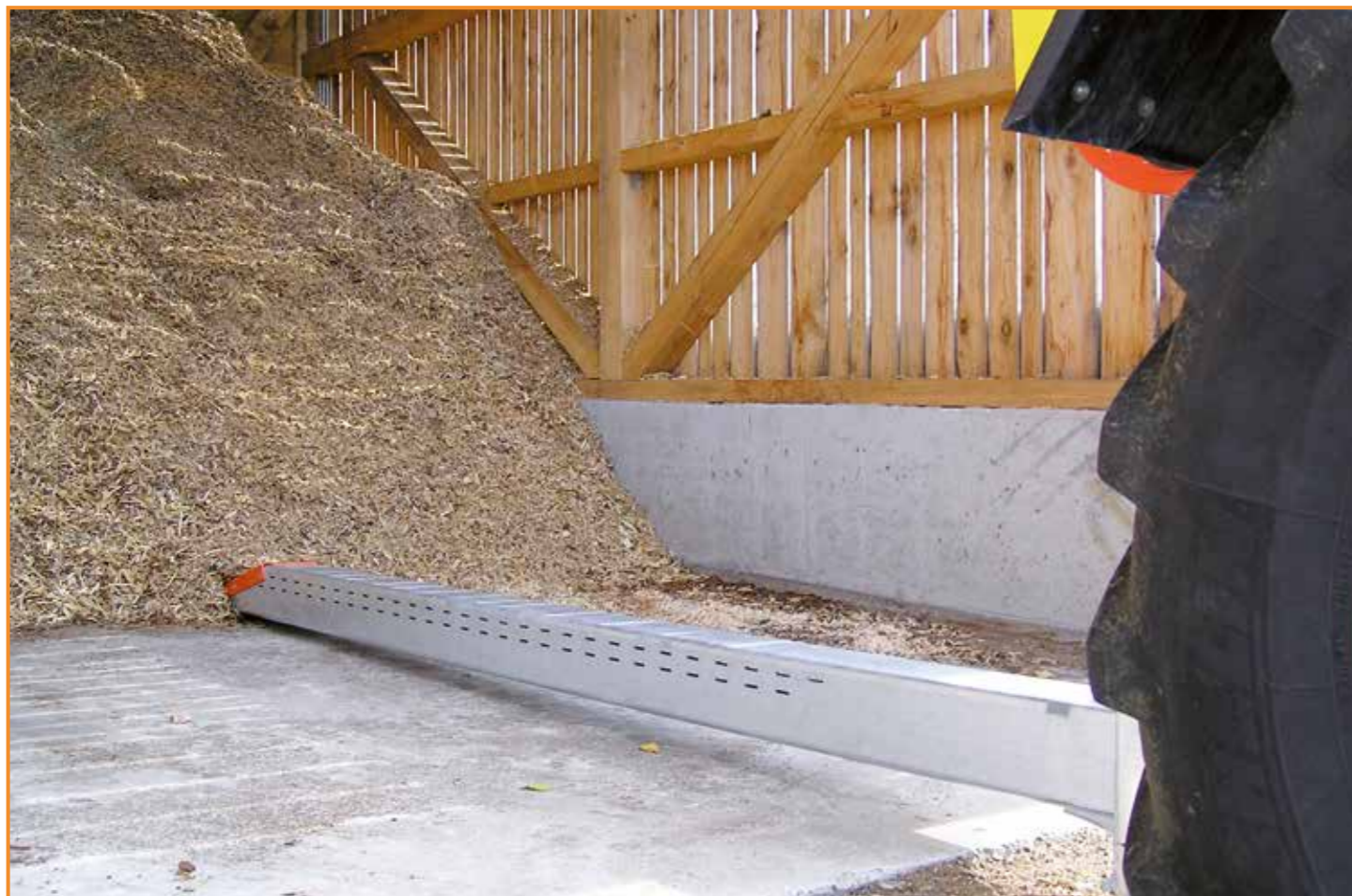
Einschub über Traktor 3-Punkt Aufhängung
