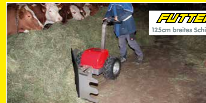
SCHNEESCHIEBER 125cm breites Räumschild mit Kunststoffleiste
