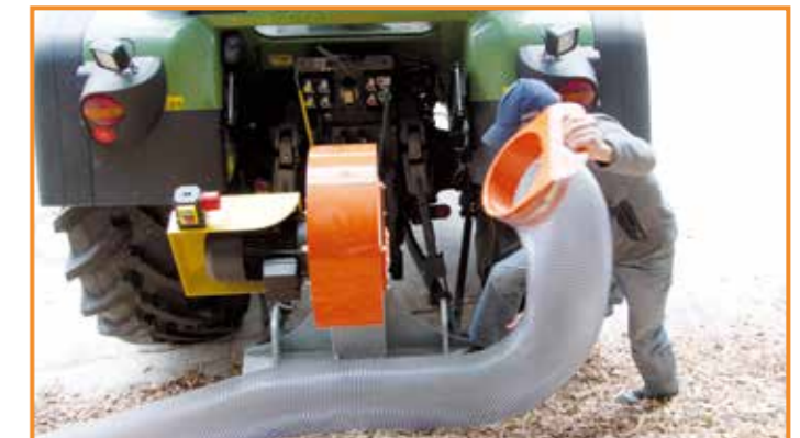
Schlauch mit Schnellwechselanschluss
