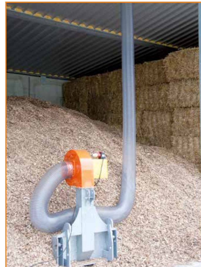
Dachzwischenraum wird abgesaugt
