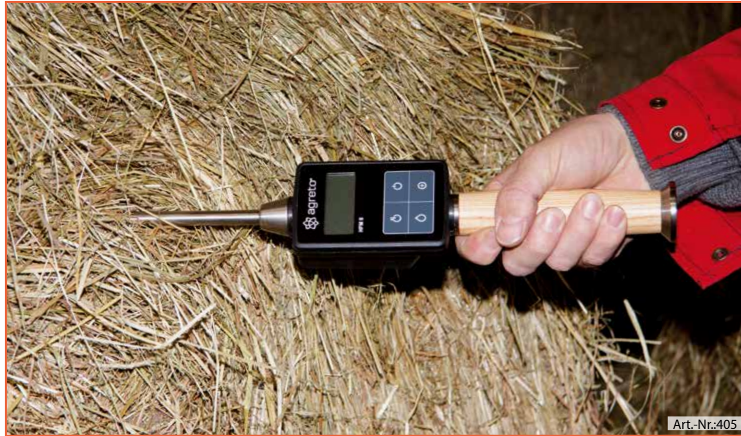
Heufeuchtemesser mit Temperaturkontrolle zur Kontrolle der Lagerfähigkeit
