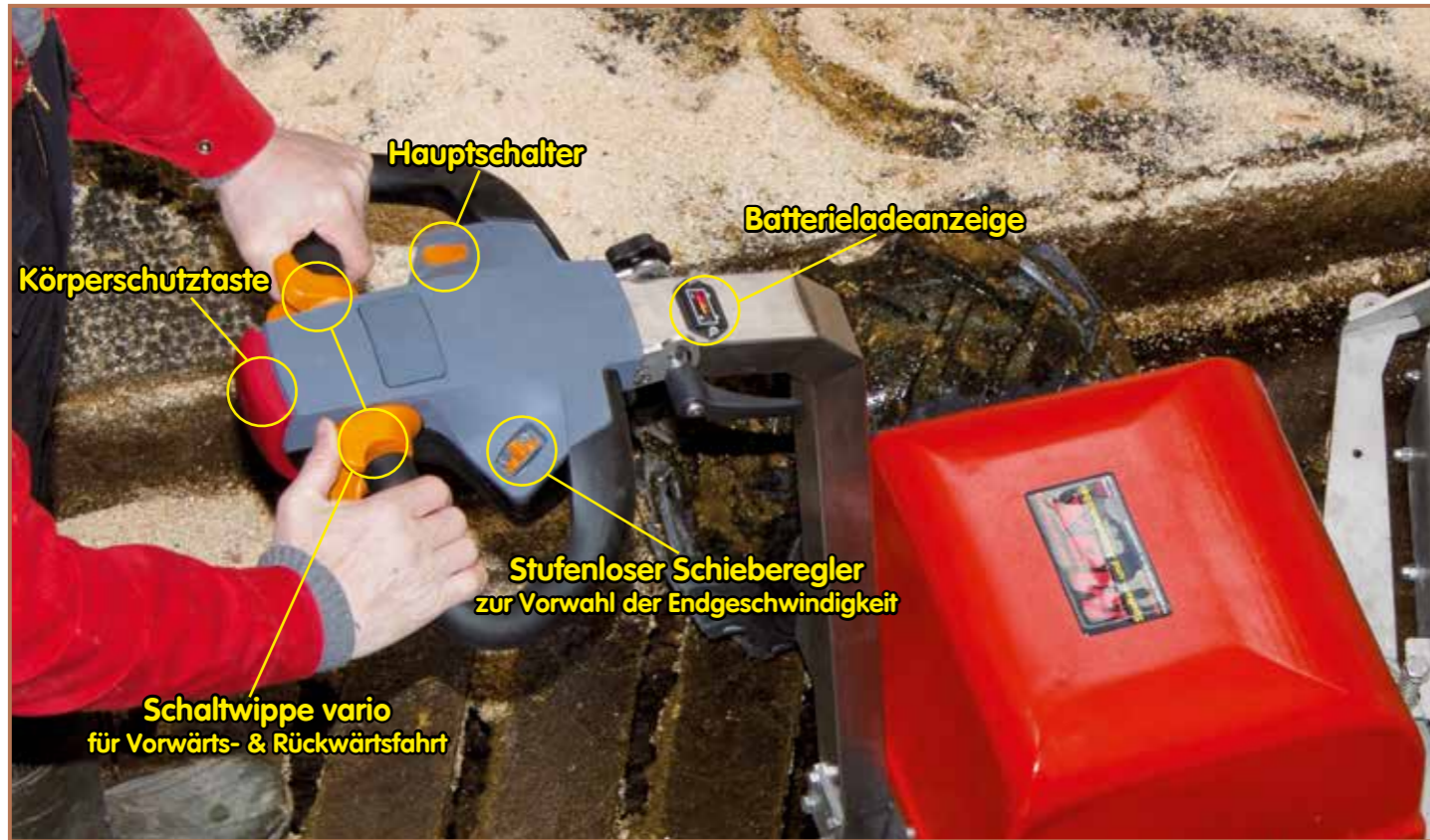
Ergonomisch geformter Deichselkopf für eine entspannte Bedienung
