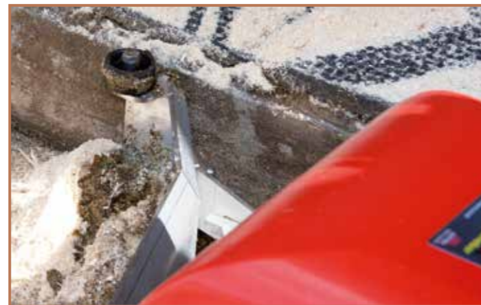
Seitliche Anlaufrollen am Schieber verbaut
