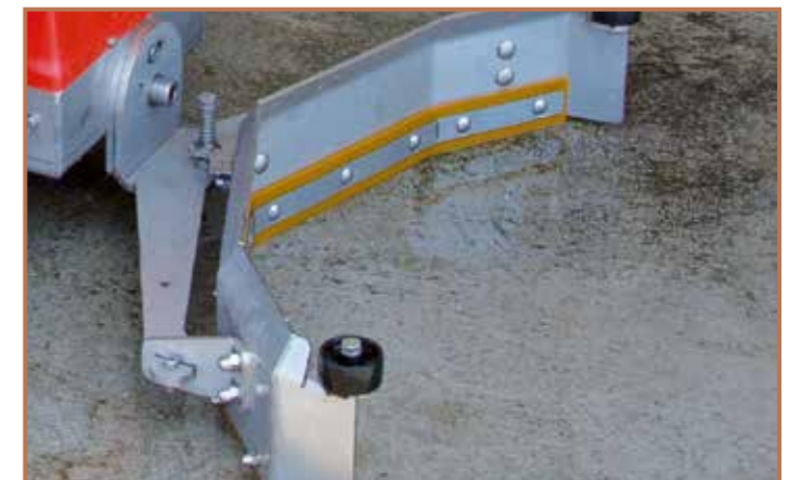
Reinigungsleiste aus Vulkollan (wendbar)
