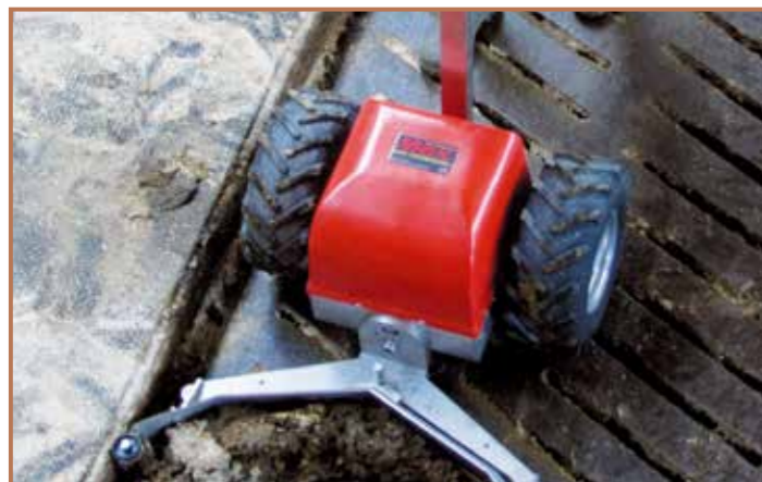
Breite Bereifung - Frostschutz befüllt
