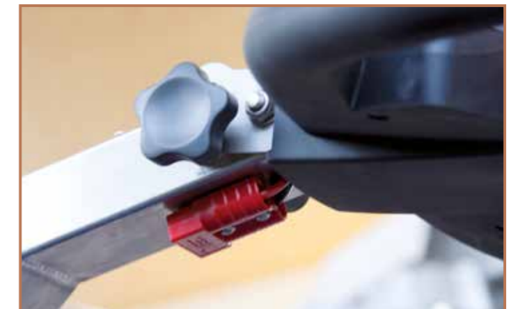
Batterieladestecker geschützt angebracht
