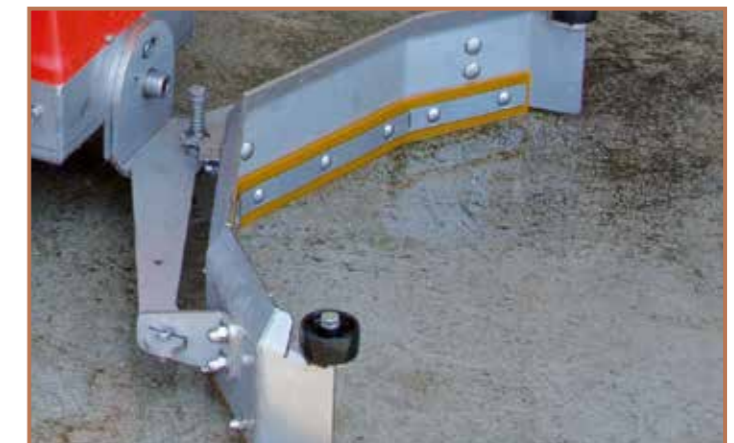
Reinigungsleiste aus Vulkollan (wendbar)
