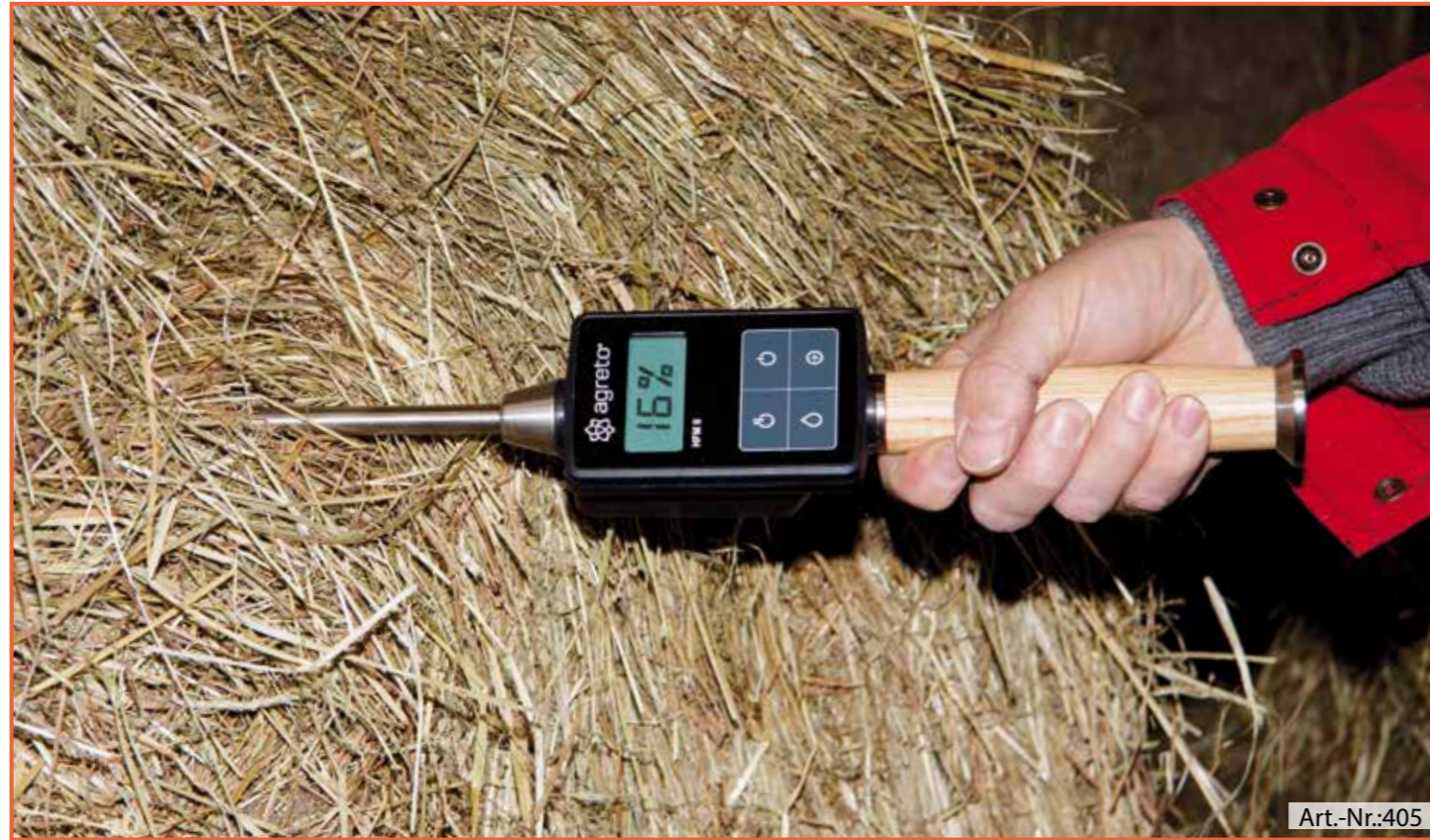
Heufeuchtemesser mit Temperaturkontrolle zur Kontrolle der Lagerfähigkeit
