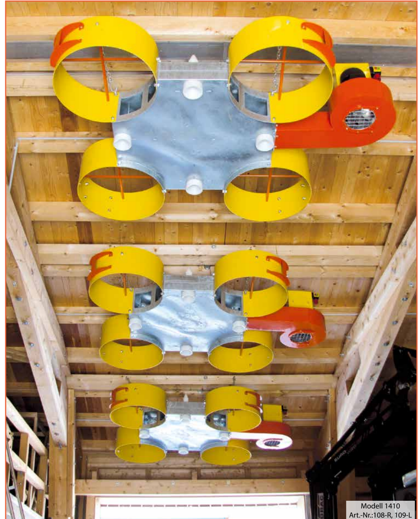
3 Belüftungsmodule Mod. 1410 für 24 Rundballen werden mittels Elektrowinde hochgezogen
