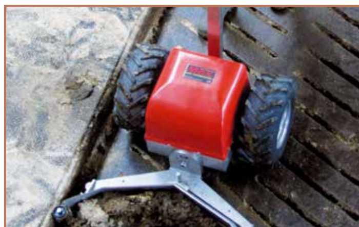
Breite Bereifung - Frostschutz befüllt
