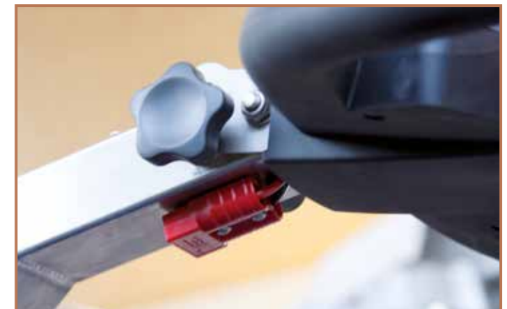
Batterieladestecker geschützt angebracht
