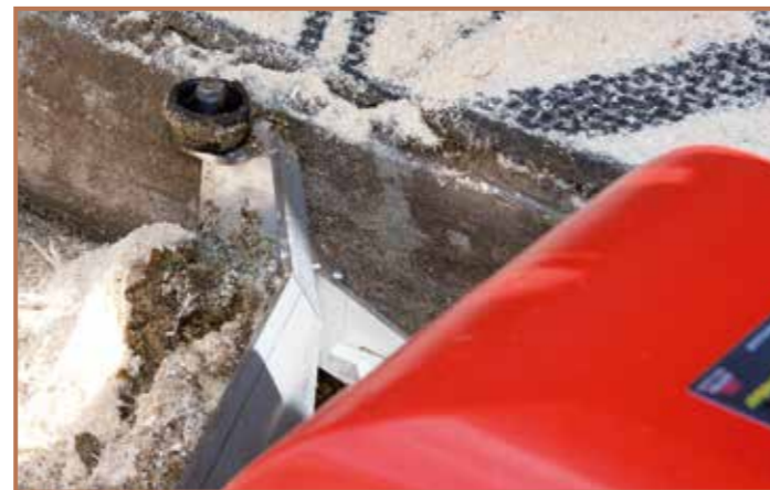
Seitliche Anlaufrollen am Schieber verbaut
