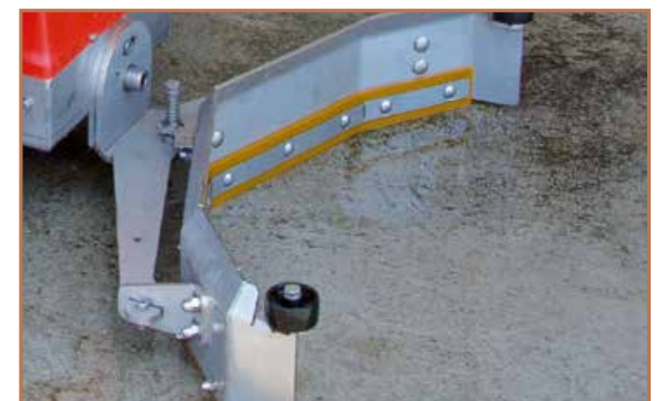
Reinigungsleiste aus Vulkollan (wendbar)
